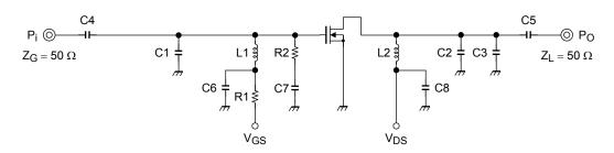
C1: 20 pF C2: 17 pF L1: φ0.6 mm enamel wire, 5.5ID, 5T L2: φ0.6 mm enamel wire, 5.5ID, 7T R1: 6.8 kΩ R2: 56 Ω
